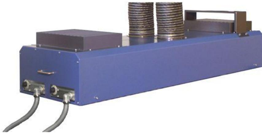
空冷式 UV ブリッジ・モデルは、シルクスクリーン印刷適用での UV インキ、UV ワニス、UV 接着剤およびコーティング用に設計されました。ブリッジ・モジュールは、一方の 1/2 個の UV ランプ (Hg および最大 120W/cm、各々) で利用可能です。
